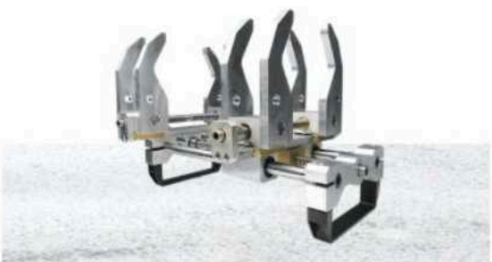
MÁQUINA FUSIONADORA MÓVIL Fusiona tubos con fittings
